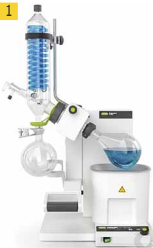
1 Rotavapor® R-300 con bagno riscaldante B-301
