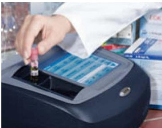
Con il DR3900, le letture effettuate con cuvetta in rotazione vengono registrate su 10 posizioni diverse durante una rotazione. **I valori erratici sono identificati ed eliminati ed è calcolata la media dei valori misurati.** Gli errori e le contaminazioni per le celle e le celle tonde vengono rilevate, pertanto viene determinato **un risultato estremamente preciso.**
