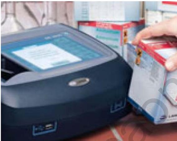
La tecnologia RFID è innovativa anche nell'**identificazione dei Test in Cuvetta**: posizionando il Test in Cuvetta davanti al modulo RFID, esso viene **automaticamente riconosciuto**, la **data di scadenza è documentata**.
